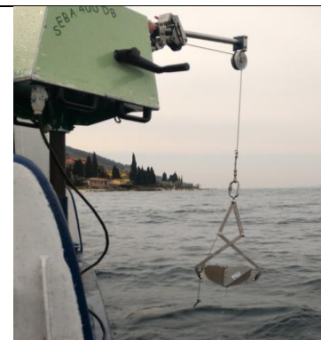
Foto - ARPAV - DL Verona. Benna per il campionamento del sedimento (tipizzazione del macrobentos). - Malcesine 2016
